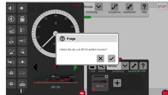
Die im System angemeldete Dampflok BR50 muss nun gelöscht werden (dafür gibt es mehrere Möglichkeiten in der Central Station). Nach Bestätigung der Sicherheitsfrage (siehe Bild oben) wird der Decoder automatisch neu angemeldet, nunmehr als „BR 211“.
