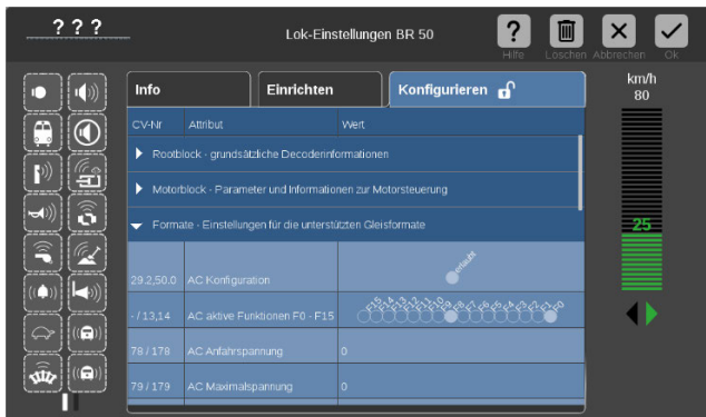
Beispielsweise können unter „Formate“ Einstellungen für den AC-Analogbetrieb vorgenommen werden.
