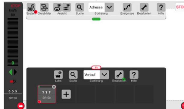
Durch Betätigung des roten Loksymbols wird die angemeldete Lok auf den Regler übernommen.
