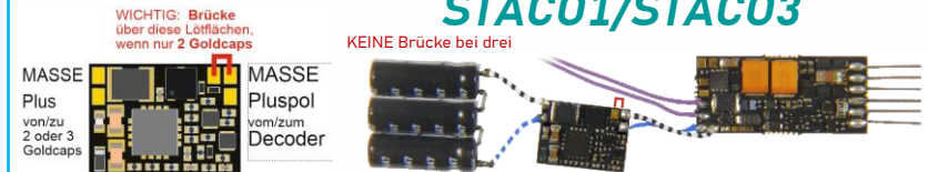
STAC01: 10 x 7,3 x 2 mm (CAD 2:1 vergrößert)
