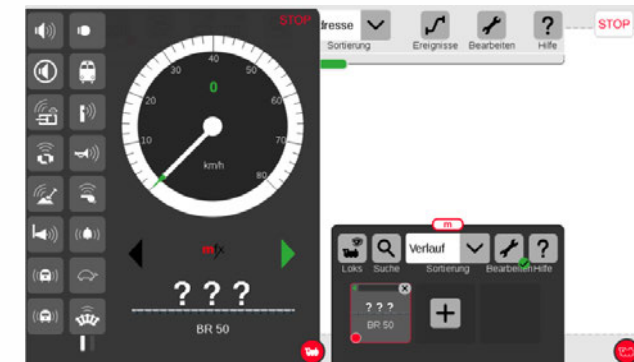
Nach Vergrößern des Reglerbalkenfensters sind Tacho und Funktions-Symbole (deren Auswahl bei der Anmeldung aus dem Decoder geladen wurden) zu sehen. Die Lok ist per Reglerknopf fahrbar.
