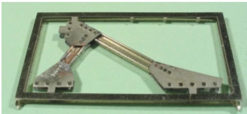
Vor dem Heraustrennen des Seitenteils sollte man noch die rechteckige Grundplatte, an der später die Holzbohle befestigt wird, anbringen. Die geätzten Langlöcher geben die Position vor. Der einseitig angeätzte Streifen zeigt dabei nach oben, wird anschließend nach hinten umgebogen und verschließt
