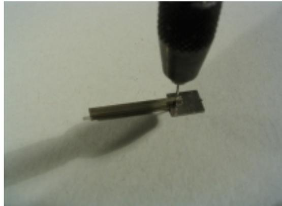
Die Schraubbefestigung wird anschließend durch eingelötete – und etwas nach oben überstehende – Drahtstifte angedeutet (Bolzen mit Muttern sind in dieser Größe leider nicht erhältlich). Der Schienenfuß ist abschließend gegebenenfalls plan zu schleifen.
