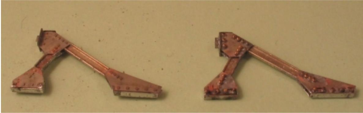
Jedes Seitenteil ist nun auf den Schienenfuß eines um 180 Grad gedrehten Peco-Z-Profils zu löten. Dieses Profil hat eine Länge von 27,50 mm und bekommt zuvor den entsprechend langen Streifen mit den angeätzten Schraubenenden auf eine Seite des Schienenfußes aufgelötet.
